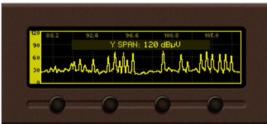
Выбрано 120 dBμV Y span
