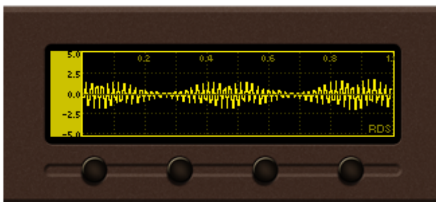
Осциллограф с RDS выбранным в качестве источника сигнала
