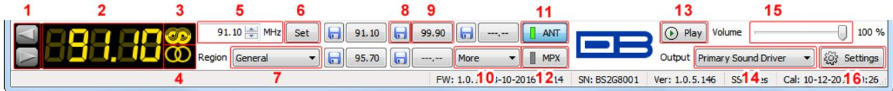
1. Los botones [IZQUIERDA] y [DERECHA] se usan para ajustar la frecuencia del sintonizador. ([vea “Settings> Tuner> Step” en la página 30](#))
