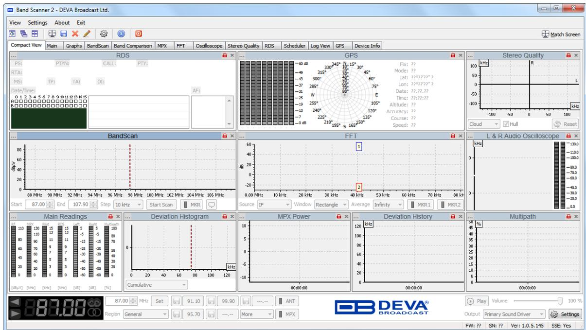
Después de conectar el dispositivo a la PC que ya tenga el Software instalado, el software ajustará la unidad con los datos iniciales. En caso de uso previo del dispositivo, los últimos ajustes como la frecuencia y los niveles se asignarán en el dispositivo. Si todo está bien y no se detectan problemas, el software se verá así:
