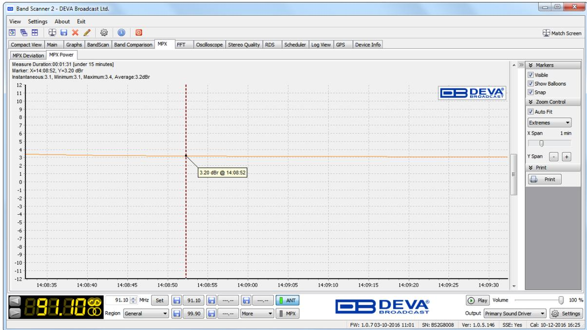
La potencia de modulación es una potencia relativa de la señal MPX promediada en 60 segundos. 0 dBr corresponde a una potencia media de una señal equivalente a la potencia de un tono sinusoidal que provoca una desviación de pico de 19 kHz. La compresión intensiva de la dinámica de audio, así como el aumento de la desviación de cresta global, hace que la potencia de modulación aumente.
